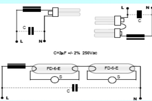
schema di collegamento ballast FC13 + lampada + starter (S)
