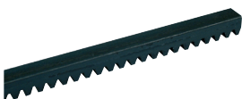
ACS9020 CREMAGLIERA M4 in metallo (sez. 22 x 22 mm) (fino a 2200 kg) in barre da 2 m al m 20 €
