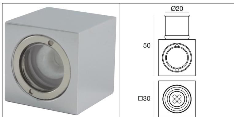
Incasso a parete e incasso a soffitto a singola emissione per applicazione indoor. La sorgente luminosa LED, di colore bianco caldo, con distribuzione luminosa 30°, è composta da 1 LED powerled, con una CCT 3000 K ed un CRI 80; il flusso luminoso della sorgente è di 121 lm, con un'efficienza di 61 lm/W.
