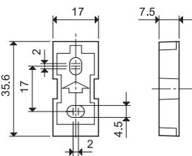
Supporto per fissaggio a pannello, plastica, larghezza 17.5 mm per 70.11 e 70.61 | 020.01
