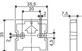
Supporto per fissaggio a pannello, plastica, larghezza 35 mm per 70.31 e 70.41 | 011.01
