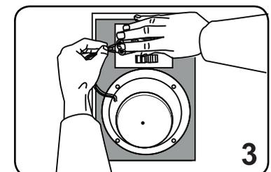
Collegare il cavo diffusore ai morsetti a vite. Assicurarsi che la polarità sia corretta.
