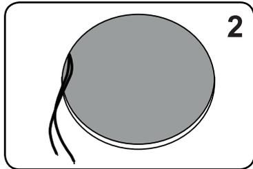
Alla stesura del cavo dell'altoparlante dall'amplificatore fino al punto di installazione, assicurarsi che il cavo finisca circa 30 cm (12") oltre alla foratura del muro.
