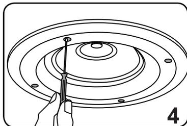
Stringere le viti finché si sente il telaio, premere fermamente contro il muro. Ciò indica che il morsetto è allungato ed è afferrato al muro.
