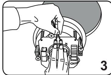
Collegare il cavo diffusore ai morsetti a vite. Assicurarsi che la polarità sia corretta.
