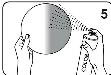
La griglia a copertura del diffusore a incasso a muro/soffitto può essere facilmente dipinta con vernice normale. Se la griglia è dotata di un ulteriore rivestimento, questo deve essere rimosso prima della verniciatura.
