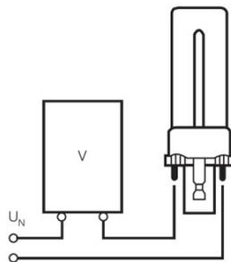
Schema di cablaggio
