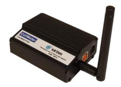
Lo strumento CellMeter permette di effettuare una scansione dei canali GSM ed UMTS presenti nelle bande 900 e 2100 MHz, fornendo per ognuno di essi la potenza del segnale espressa in dBm, l'identificativo della cella sorgente (CELL ID) e relativo codice LAC (Local Area Coordination).
