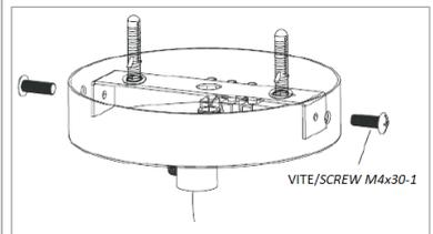
2. Forare il soffitto o la parete come da disegno. Opening screw holes on the ceiling or wall as per drawing. Fissare la staffa al soffitto con i tasselli, avvitare le viti M4x30 e le guarnizioni 2. Fixing the holder to the ceiling with wall anchor, screw M4x30 and gasket 2. Fissare il rosone sulla staffa con le viti M4x30-1 / Fix the whole rose in the holder with screw M4x30-1
