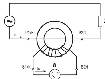
Nel collegamento di tutti i trasformatori amperometrici è importante rispettare i sensi di percorrenza della corrente.
