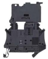
morsetto portafusibile con morsetti a vite grandezza morsetto 4,0 mm2 larghezza morsetto 6,2 mm colore nero fusibile 5 x 20 mm
