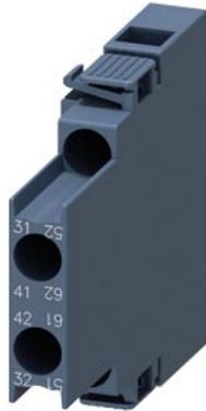
blocchetto di contatti ausiliari laterale, 2 NC via di corrente 1 NC, 1 NC per 3RH2 e 3RT2 morsetto a vite R: 31/32, 41/42 L: 51/52, 61/62
