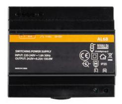
Alimentatore da barra DIN (6 moduli) Input 100-240 Vac 50Hz 1,8A Output 24 Vdc 6,25A, 150W Colore nero Dimensioni 103x58x90 mm (LxHxP) Peso 0,35 Kg
