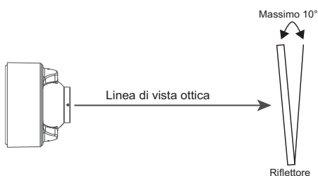
Figura 2-5: Linee guida per il montaggio del riflettore
