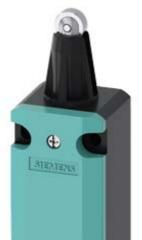
Interruttore di posizione custodia in metallo 40 mm secondo EN 50041, connessione dell'apparecchio 1x (M20 x 1,5) 1NO/1NC contatti ad azione rapida, pulsante con rotella con 3 mm di sovracorsa e rotella in acciaio inox 13 mm
