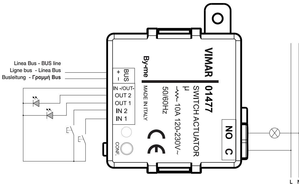
**2. Utilizzi Plug&Play: Tre pulsanti in parallelo su IN1 e uno su IN2 - Plug&Play uses: Three buttons in parallel to IN 1 and one of IN2**
