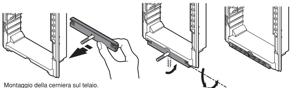
Montaggio della cerniera sul telaio.
