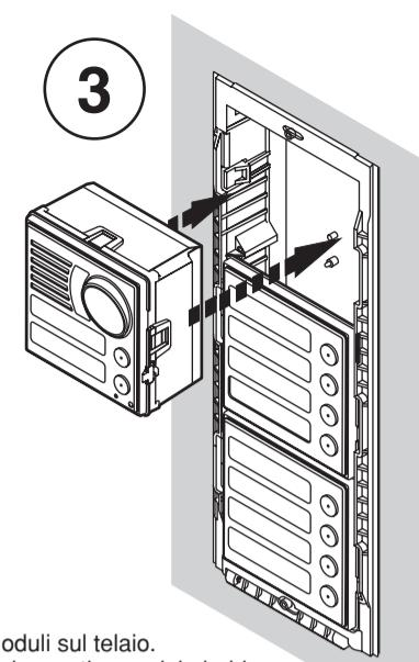
Montare i moduli sul telaio.
