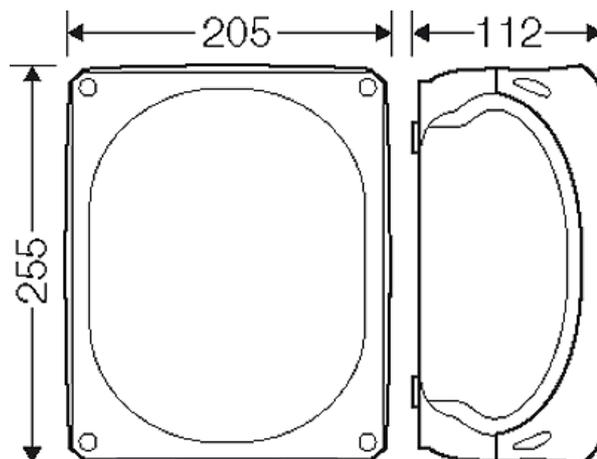
"resistente alle intemperie" per l'installazione all'aperto senza protezione, scatola a pareti lisce
