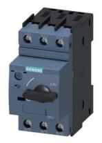
interruttore automatico grandezza costruttiva S00 per protezione motore, CLASS 10 sganciatore A 0,18...0,25 A sganciatore N 3,3 A morsetto a vite potere di manovra standard
