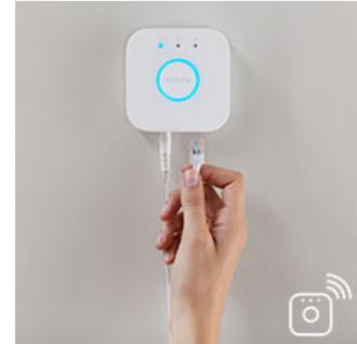
Collega le luci Philips Hue al Bridge per poterle controllare dal tuo smartphone o tablet tramite l'app Philips Hue. Oppure controllale grazie al telecomando Dimmer Switch Philips Hue per accensione/spegnimento e le funzioni di regolazione intensità.
